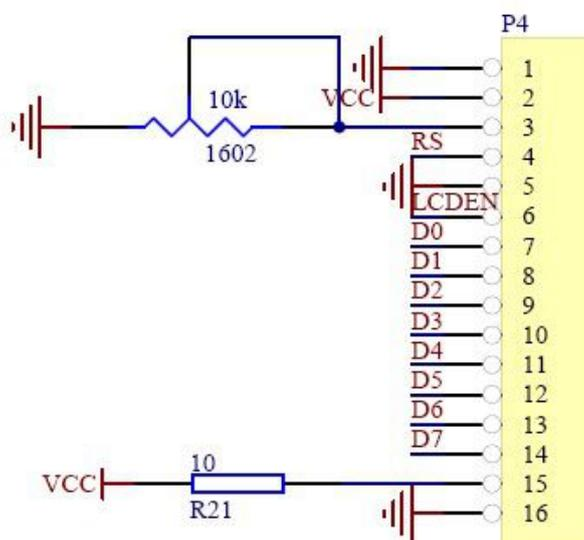
为了调整 LCD 的背光，在引脚 15 处最好接一个可变电阻，以调整背光亮度，或使用 PWM 实现软件背光调整。
