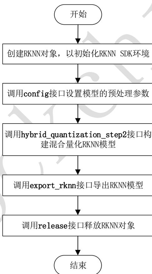
图 3-3-3-2 混合量化第三步接口调用流程
