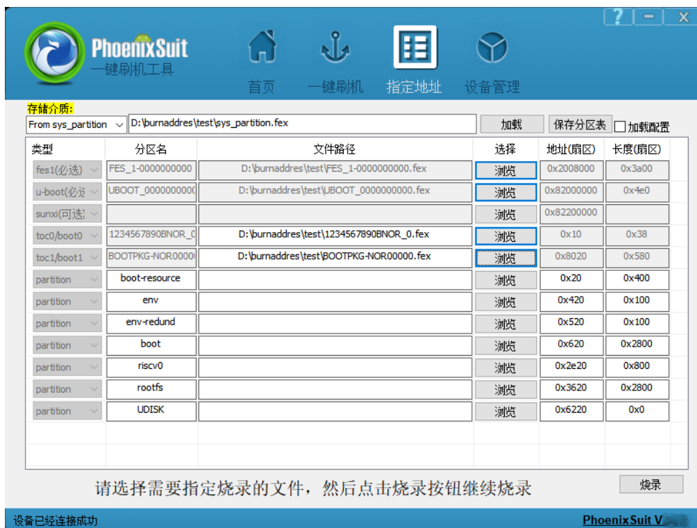
图 3-56 删减分区烧录开始烧录前工具界面示意图
