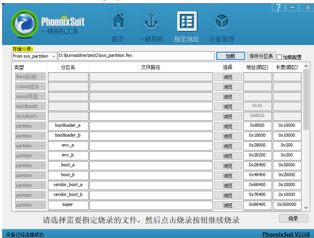
图 3-61 EMMC 介质加载 sys_partition.fex 示意图
