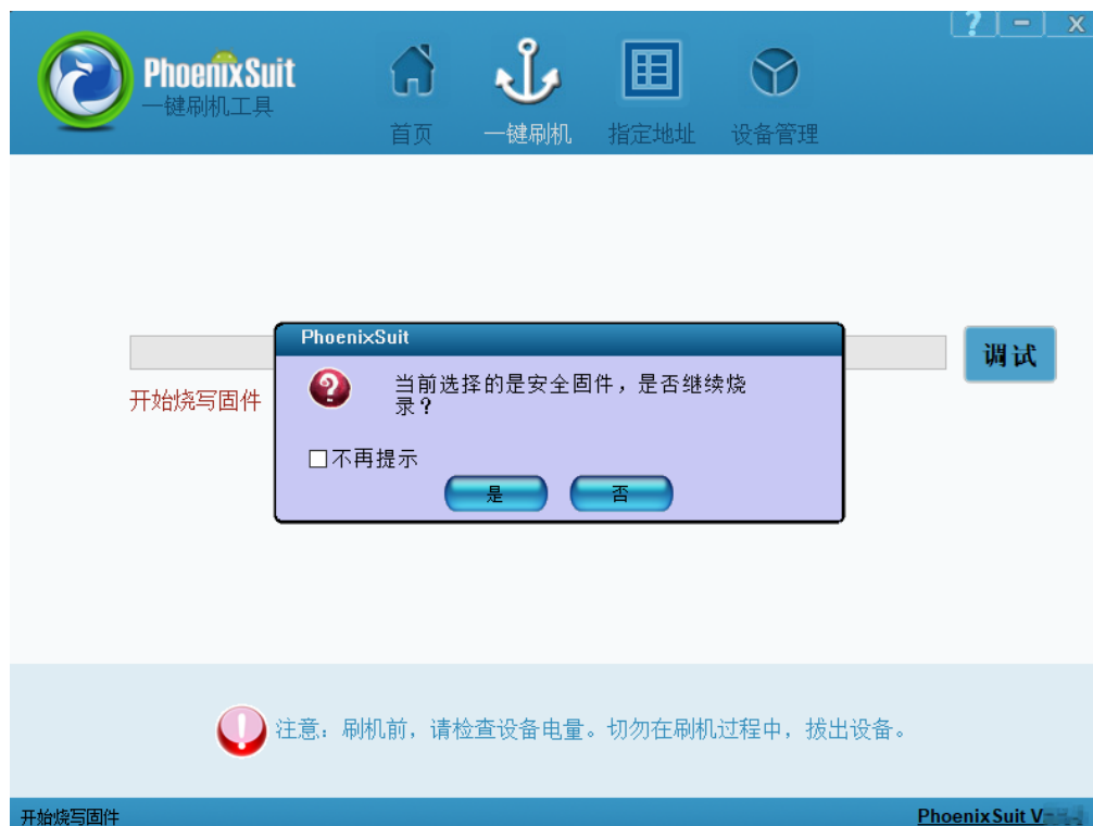
图 3-14 烧录安全固件弹窗提示示意图
