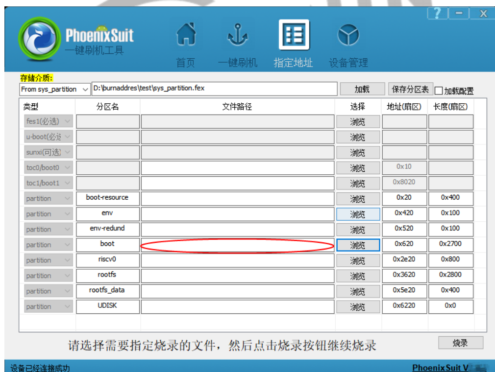
图 3-42 缩短分区长度之分区文件长度大于分区长度清空文件路径示意图
