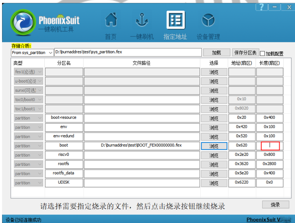
图 3-44 缩短分区长度之分区长度小于分区文件长度清除分区长度示意图
