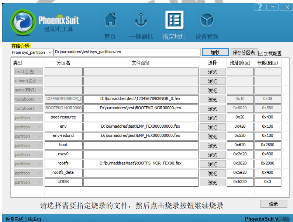
图 3-24 From sys_partition 方案导入配置效果示意图
