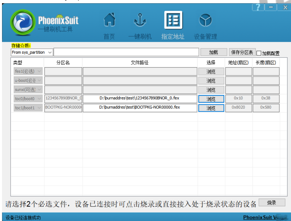
图 3-65 不导入 sys_partition 之 SPI-NOR 烧录选择 boot0 和 boot1 文件示意图
