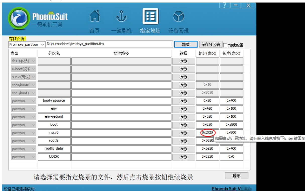
图 3-32 From sys_partition 方案修改地址效果示意图
