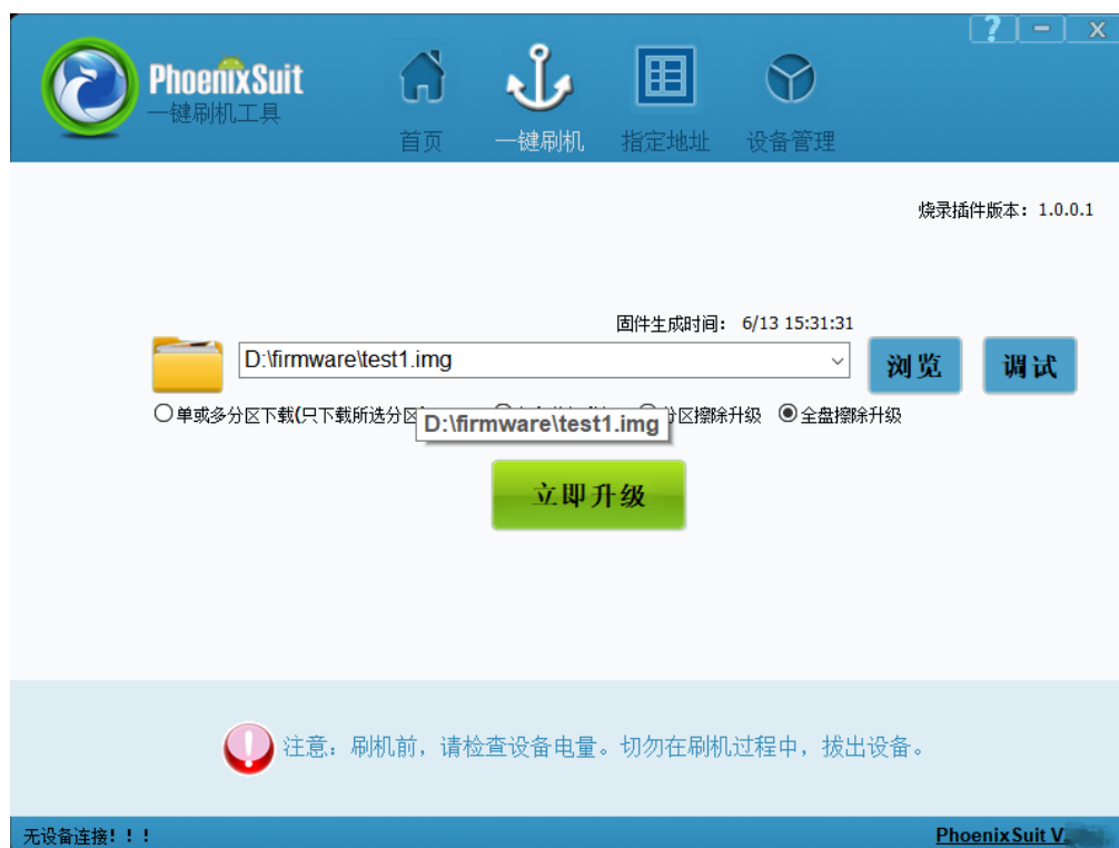
图 3-13 气泡显示固件路径示意图
