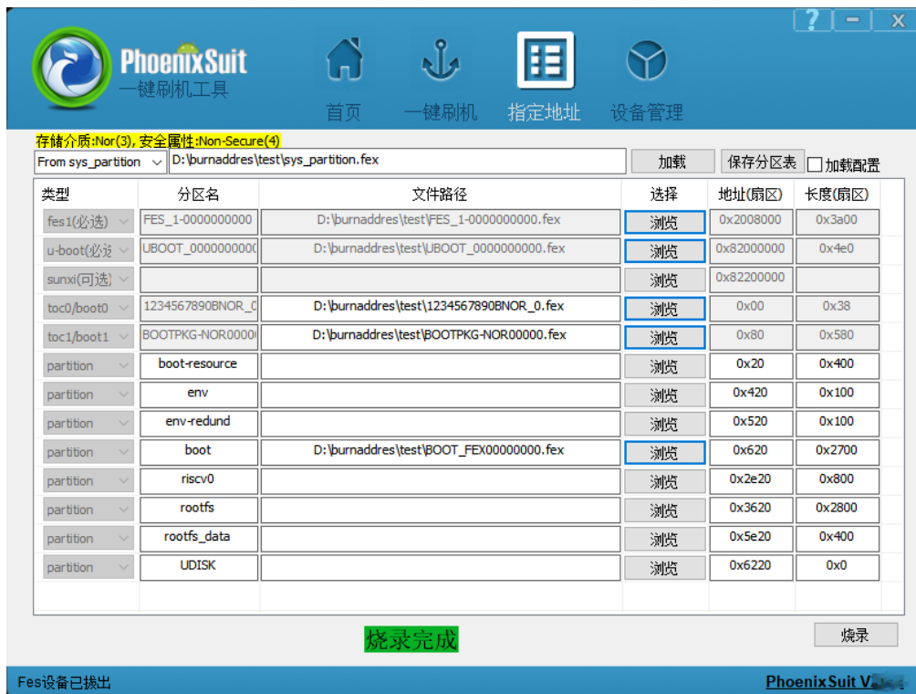
图 3-47 From sys_partition 方案缩短分区长度烧录完成示意图
