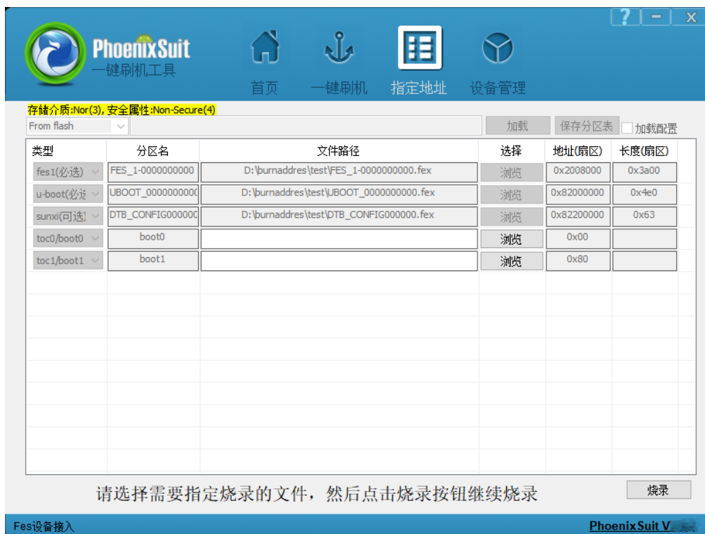
图 3-21 From flash 方案空片界面示意图
