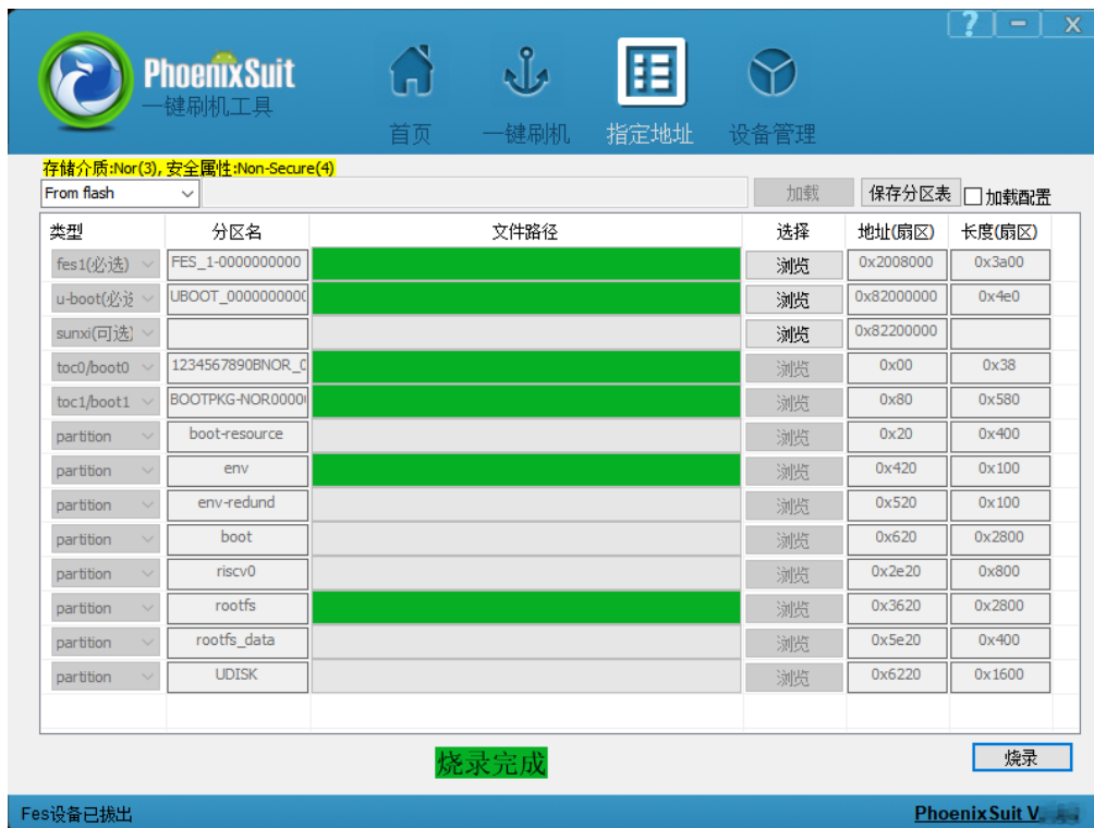
图 3-96 替换文件烧录完成示意图
