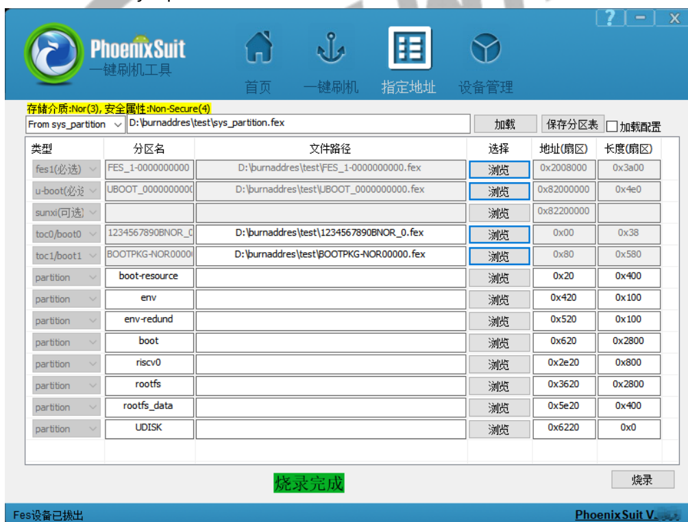
图 3-60 From sys_partition 方案 SPI-NOR 介质烧录 boot0 和 boot1 完成示意图
