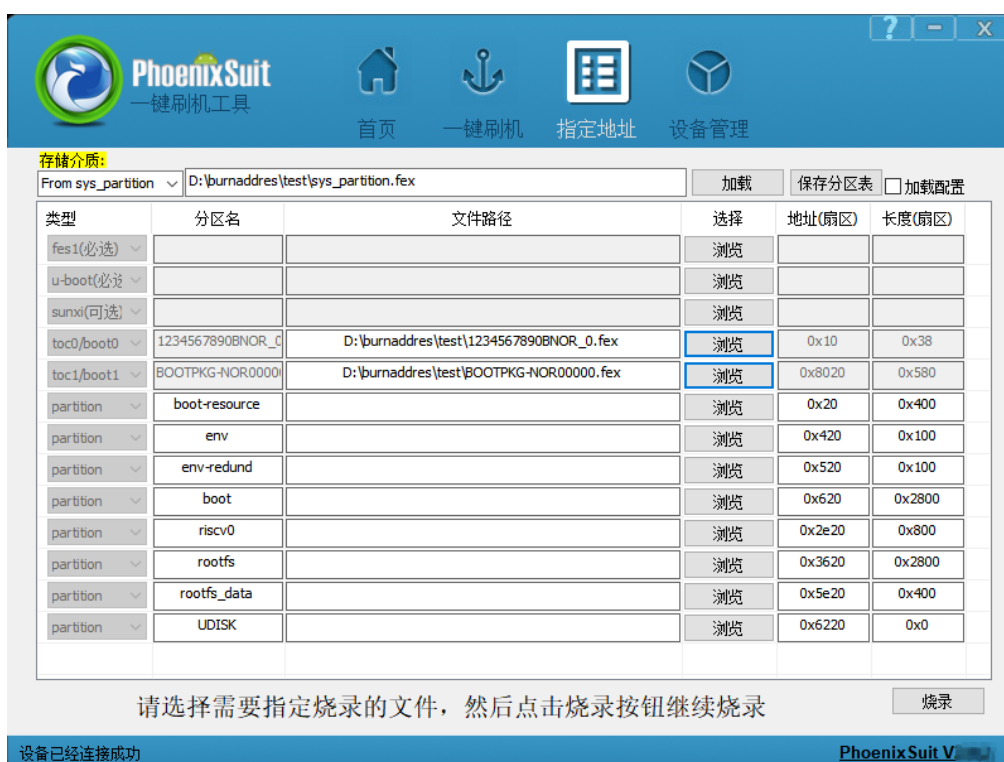
图 3-58 SPI-NOR 介质替换 boot0 和 boot1 选择分区文件效果图
