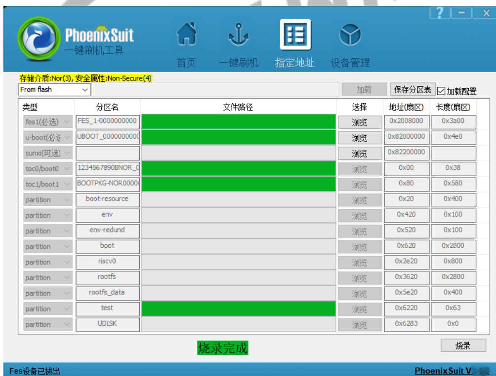
图 3-124 导入配置烧录完成示意图
