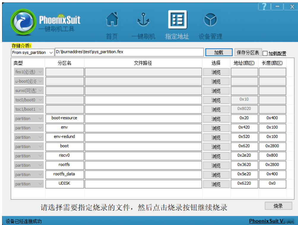
图 3-23 加载 sys_partition.fex 完成界面示意图
