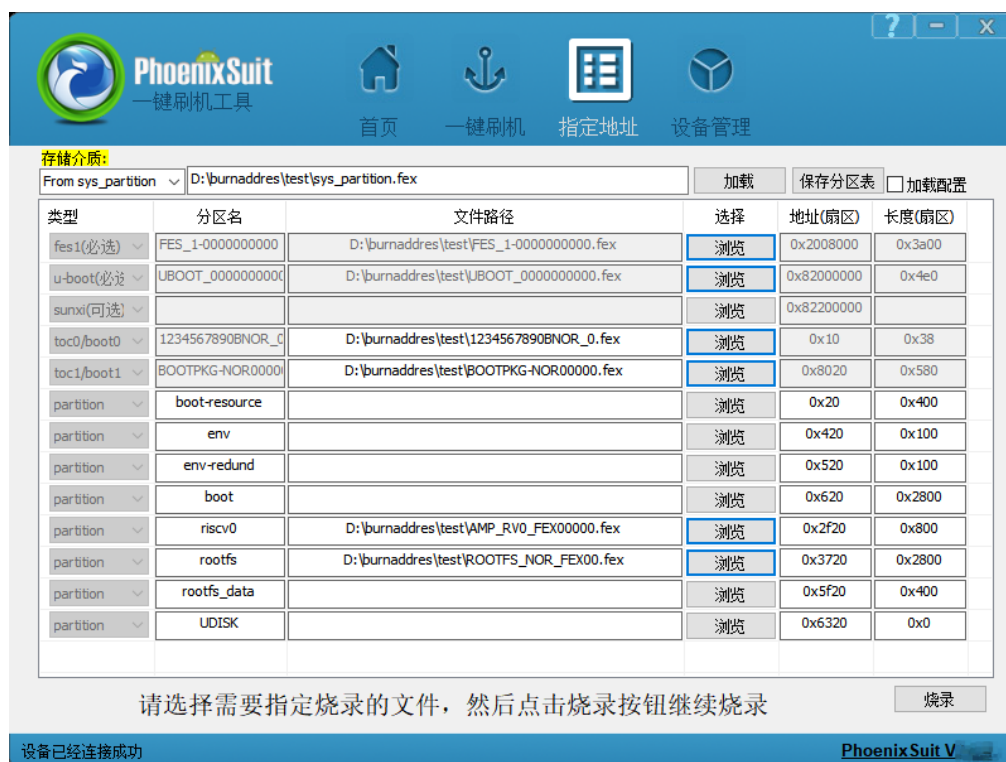
图 3-35 工具提示地址变化弹窗示意图
