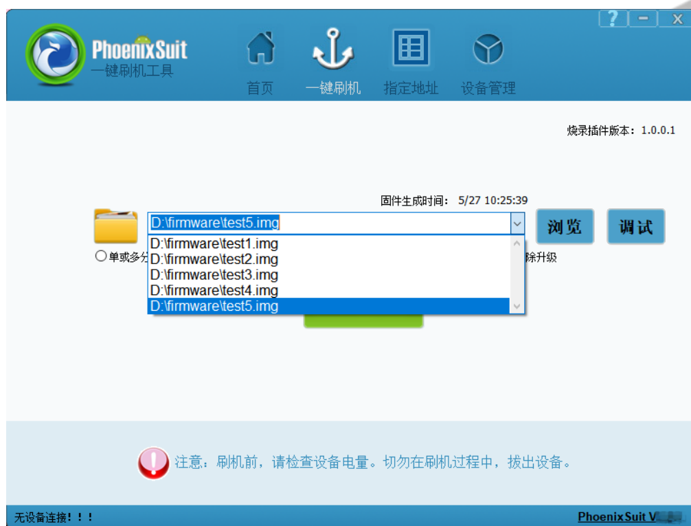
图 3-10 固件路径记忆功能示意图
