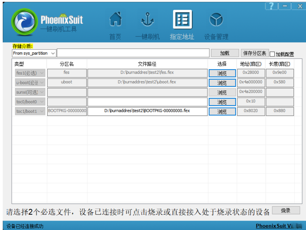
图 3-73 不导入 sys_partition 之 EMMC 烧录不选择 boot0 和 boot1 文件工具提示示意图
