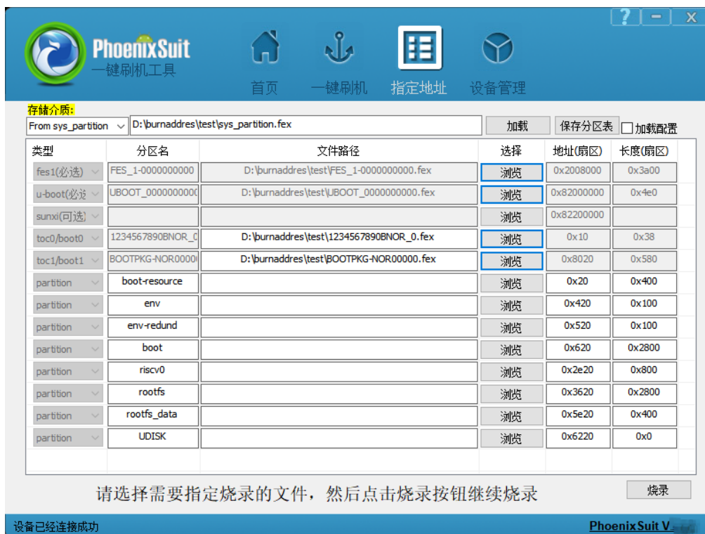
图 3-59 SPI-NOR 介质烧录 boot0 和 boot1 开始烧录前工具界面示意图
