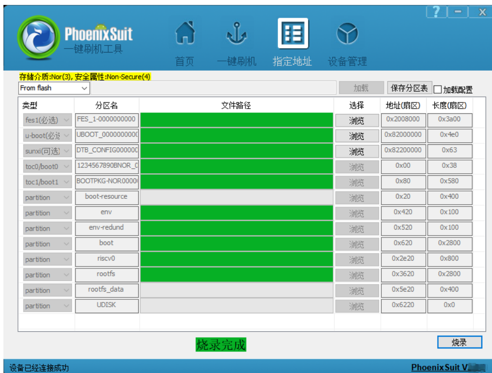
图 3-92 空片烧录完成示意图
