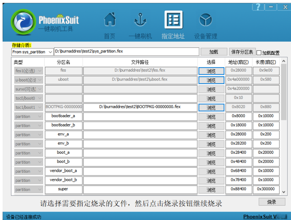
图 3-63 EMMC 介质烧录 boot1 开始烧录前工具界面示意图
