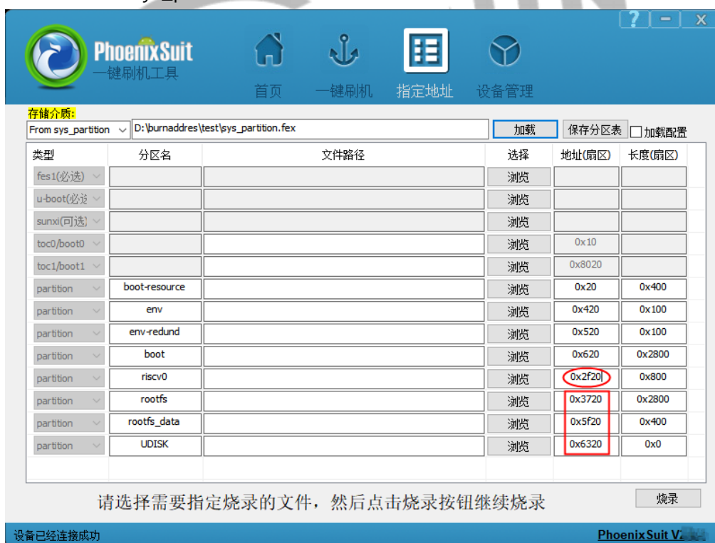
图 3-32 From sys_partition 方案修改地址效果示意图
