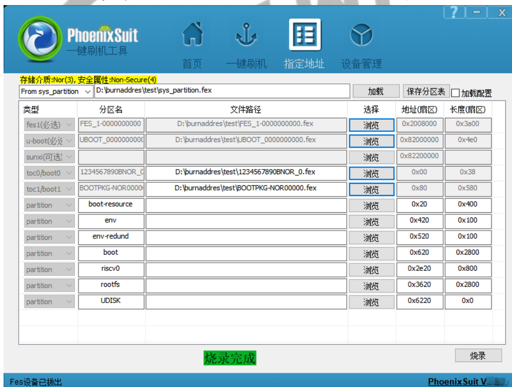
图 3-57 From sys_partition 方案删减分区烧录完成示意图
