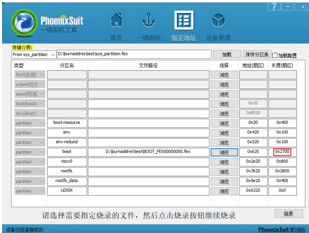
图 3-45 缩短分区长度修改完毕效果示意图
