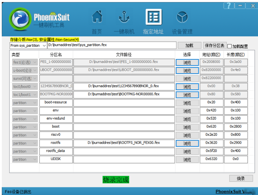
图 3-40 From sys_partition 方案增长分区长度烧录完成示意图
