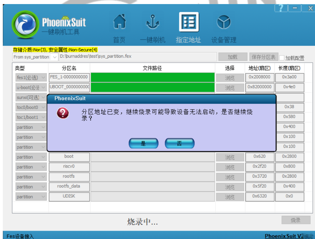
图 3-35 工具提示地址变化弹窗示意图
