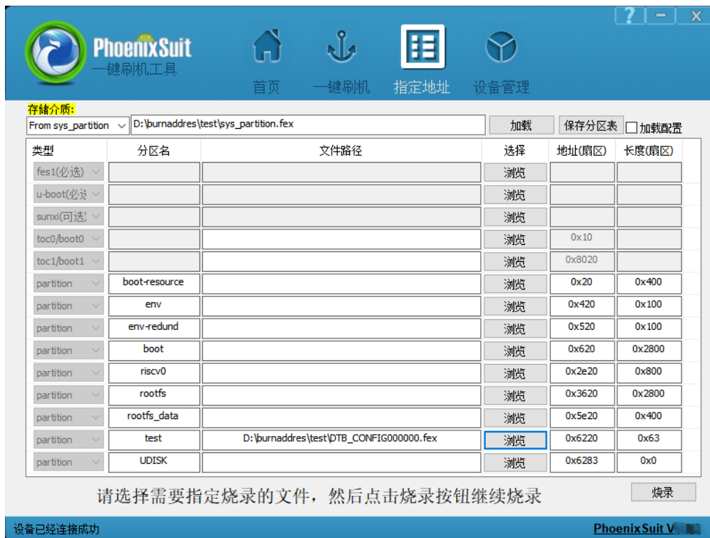
图 3-126 From sys_partition 方案添加分区效果示意图
