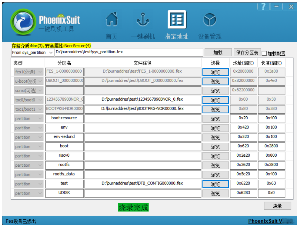
图 3-53 From sys_partition 方案增加分区烧录完成示意图
